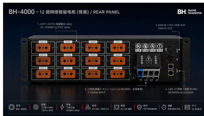
后面板：12路40A输出、三相五线输入、DMX IN/OUT、双LAN网络级联
