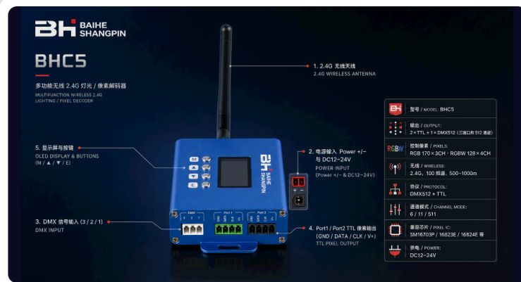
正面接口：DMX INPUT、Port1、Port2、显示屏与按键
