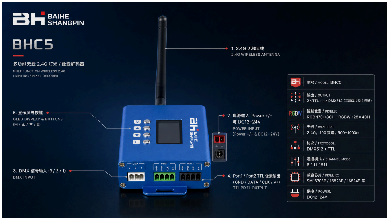
最新实物接口标识图：DMX 输入、Port1、Port2、OLED 与按键
